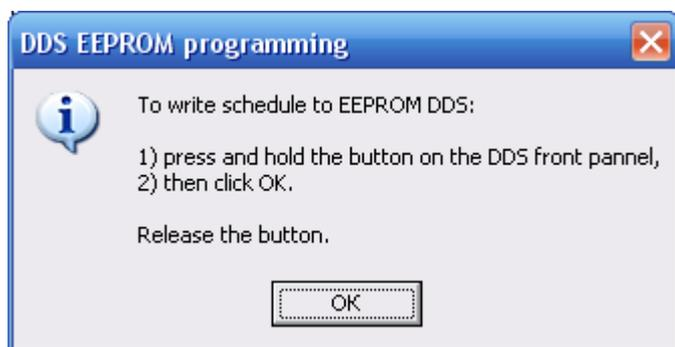
Необходимо нажать управляющую кнопку на лицевой панели синтезатора, и удерживая ее нажатой, кликнуть «OK». Начнется запись, кнопку синтезатора можно отпустить. Так сделано для защиты от случайного повреждения информации в EEPROM и подтверждения действия оператором.
